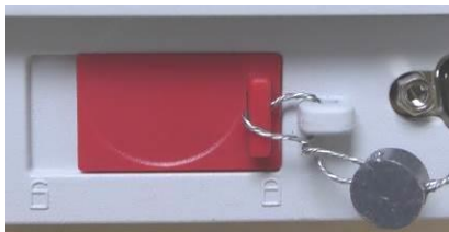
Verrouillé avec un plomb de sécurité
