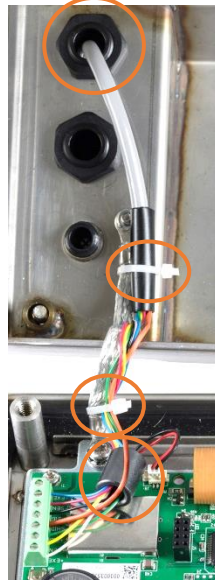
Figura 2-28: Installazione del terminale di messa a terra e della ferrite per la cella di carico analogica, IND236
