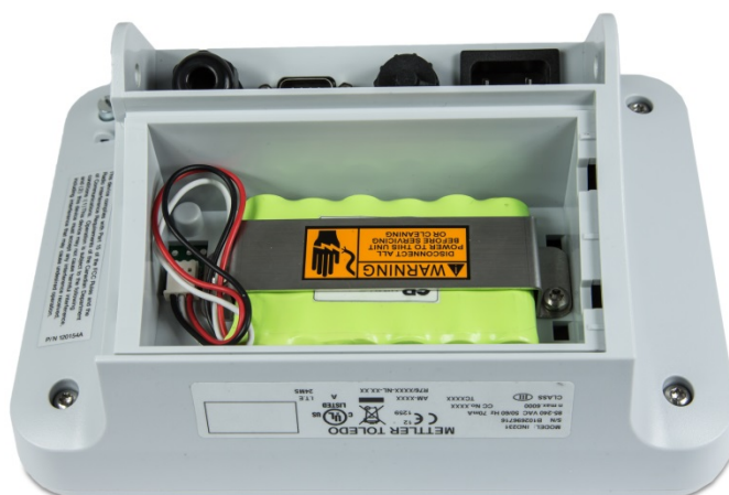
Figura 2-21: Batteria NiMH Installata in IND231
