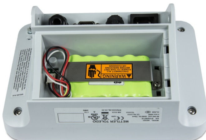
Figure 2-21: Batterie NiMH installée dans l'IND231
