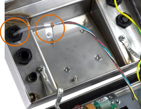
Abbildung 2-31: Einführung des Wägezellenkabels in das IND236-Gehäuse, mit Gehäuseerdungsklemme
