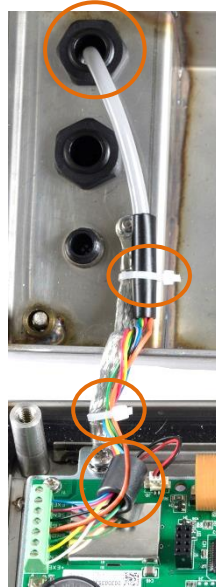
Abbildung 2-28: Stifferung der analogen Wägezelle und Ferritperleninstallation, IND236
