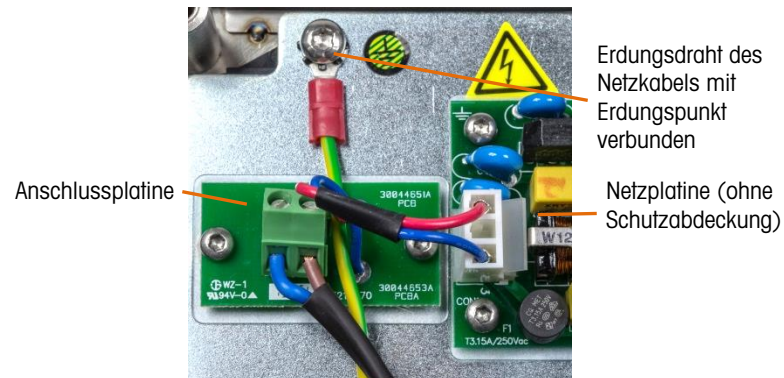
Abbildung 2-18: IND236 – Netzplatine und Erdung
