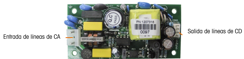
Figura 2-17: Tarjeta de energía
