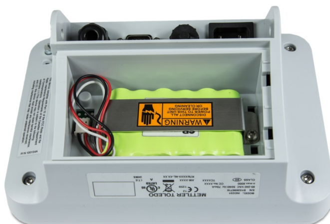
Figura 2-21: Bateria NiMH instalada no IND231
